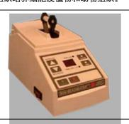
MiniBeadbeater-16 将破碎缓冲液和小陶瓷珠或者钢珠装在 4 - 16 个标准的微量离心管中,利用破碎珠在高 速运转下的相互碰撞,可以破碎微生物细胞和动植物组织。即使是较坚硬的样品如酵母菌,孢子或者含纤维的组 织都可以在 3-5 分钟内完全破碎,而且无泡沫,不产生气体,可以保持酶的活性,保护细胞器官。结合核酸提取 介质如苯酚,Gu-SCN 溶液或者其他试剂,可以边破碎边提取大量 DNA 或者 RNA。这种方法是进行 PAGE,PCR 实 验和利用抗体或者寡核苷酸探针诊断的最佳仪器。因为珠子和离心管都是一次性的,所以样品间的交叉污染绝对 是零。
