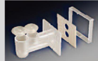
为提高工作效率，我们特别设计了在同一块玻片上放两个样品的双样品腔。它可以保障和单样品腔同样出色的实验结果
